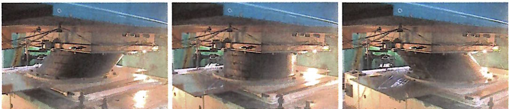
図6 (地面が動いてもゴムが変形するだけで、上の建物はほとんどゆれていない)
